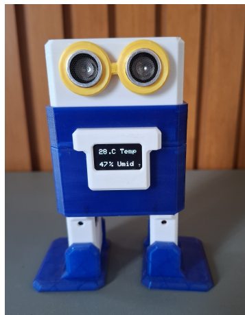
Figura 12. Medição de temperatura e umidade com exibição no OLED.
