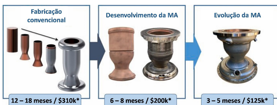
Figura 1. Comparação da fabricação convencional com a evolução da manufatura aditiva (custo em US$, equivalente a 2020, créditos da NASA) [9].
