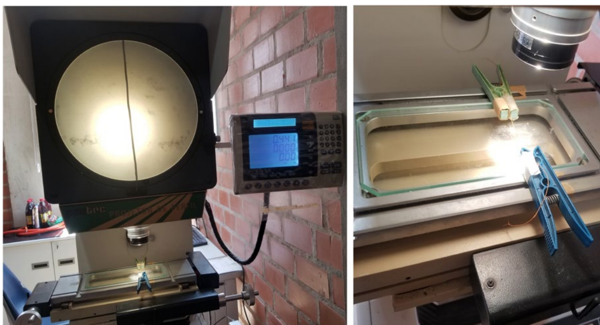
Figura 1: Análise do diâmetro das fibras de sisal em projetor de perfil.
