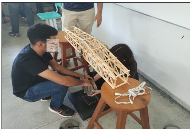
Figura 5: Equipe de alunos realizando ensaio destrutivo.
