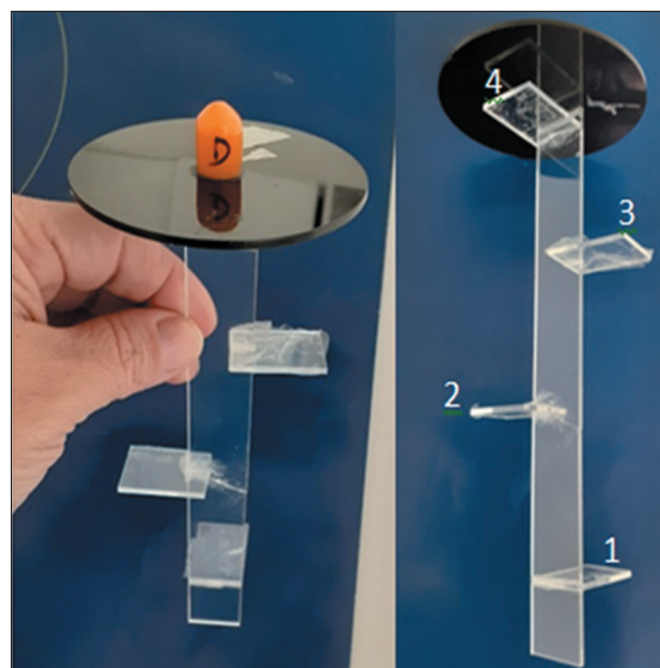
Figura 2. Imagem da régua dosimétrica, confeccionada em polimetilmetacrilato.
