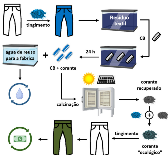
Figura 7. Esquema proposto para recuperação de corantes têxteis utilizando CB para geração de corante ecológico a partir da calcinação de poluentes adsorvidos em forno acoplado à energia solar
