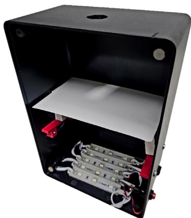
Figura 1. Câmara escura para aquisição das imagens, com a parte frontal mostrando a base de polipropileno para posicionamento da placa de poços, abaixo, a fita de LED para iluminação constante e a parte superior com abertura para o posicionamento da câmera do smartphone
