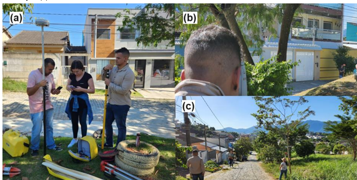
Figura 7 - Diferentes etapas de levantamento topográfico: posicionamento GNSS (a), poligonação (b) e irradiação (c)
