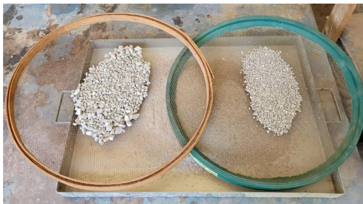
Figura 3 - Estratificação granular inicial do resíduo em estado bruto
