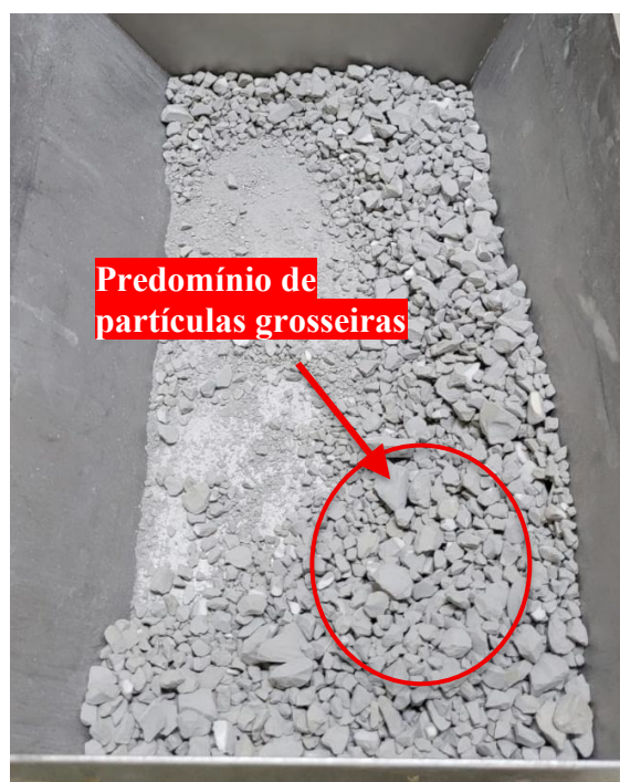
Figura 12 - Pós-moagem com esferas de alumina (24 mm)
